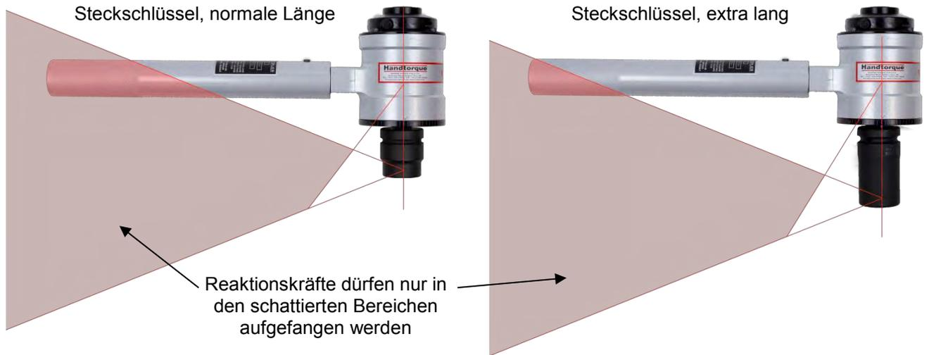
**ABBILDUNG 5 – HT4 - Serien Sicheres Stützfenster**
